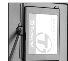
۳- پس از نصب درایو ۲،۵" براکت را در جای خود قرار داده و به سینی کیس پیچ کنید.
