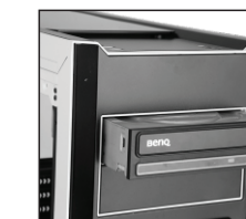
۲- درایو نوری را همانند تصویر بالا درون محفظه تعیین شده قرار دهید.
