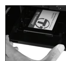
۲- تجهیزات ذخیره سازی ۲،۵" را توسط ۴ عدد پیچ به کف براکت پلاستیکی پیچ نمایید.
