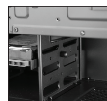
۳- جهت جلوگیری از لرزش هاردیسک، براکت را به بدنه کیس پیچ کنید.
