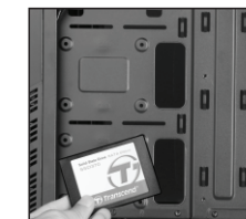
۲- درایو مورد نظر را همانند تصویر بالا در محل مربوطه قرار دهید.
