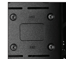
۳- توسط ۴ عدد پیچ مخصوص درایو را به محل موردنظر متصل نمایید.
