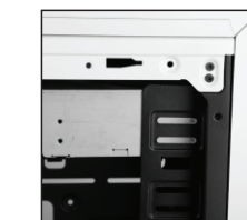
۳- توسط پیچ های مخصوص آن را محکم به دو طرف بدنه کیس ببندید.
