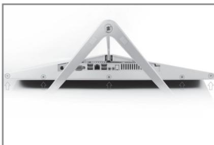
۱) پنج عدد پیچ نصب شده در لبه زیر دستگاه را باز کنید.
